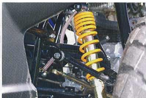
Fahrwerk: Doppelte A-Arms vorne, Federung in der Vorspannung verstellbar.
