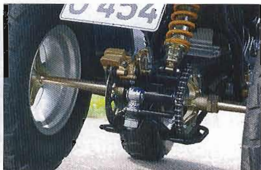
Am Heck: Scheibenbremse mit Stahlflex, AHK ohne Zulassung.
