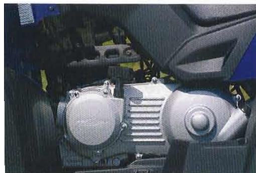
Das Herz des Stieres: Wassergekühlter, Einzylinder-Viertakter.
